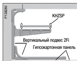
Вертикальный подвес 2Fi может монтироваться горизонтально к стене и на другом вертикальном подвесе для крепления гипсокартонных панелей для скрытого подшивного потолка.
