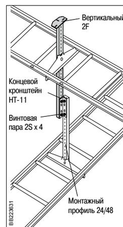
С использованием концевого кронштейна HT-11 возможен монтаж пересекающихся кабельных лестниц в разных уровнях на монтажном профиле одного типа.
