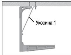
Для уменьшения отклонения Вертикального подвеса 2F при больших нагрузках на Консоль 50 используется Укосина 1, которая монтируется при помощи Т-Болта 26F и Анкерного болта M10.
