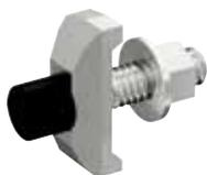
Монтаж с использованием T-болта 26F осуществляется легче и быстрее, чем с использованием пружинной гайки и болта. T-болт 26F остается в установленном положении даже без крепления комплектной гайкой. Используется для монтажа Консолей 50 и другого навесного оборудования на всех монтажных профилях и вертикальных подвесах WIBE, кроме Монтажного профиля 24/34 и Вертикального подвеса 2.
