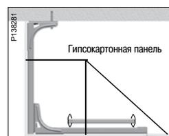
Вертикальный подвес 2Fi может использоваться для крепления декоративных гипсокартонных панелей для скрытого монтажа кабельных лестниц в зданиях и сооружениях.
