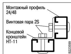
Концевой кронштейн NT-11 может использоваться для соединения под прямым углом двух Монтажных профилей 24/48 с открытыми сторонами, направленными к присоединяемым элементам, например при сборке стендов.
