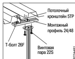
В потолках из профилированной листовой стали монтируйте Вертикальный подвес 2, 2F или 20, используя два Потолочных кронштейна 5ТР, Монтажный профиль 24/48, два Т-болта 26F и Винтовую пару 22S.
