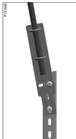
Используя Арматурное крепление для потолков, Монтажный профиль 24/48 и две Винтовые пары 22S, можно создать вертикальный подвес, который можно монтировать под углом до 10°.
