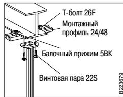
Монтируйте Вертикальный подвес 2, 2F или 20 к потолочным балкам, используя два Балочных прижима 5BK, Монтажный профиль 24/48 и Винтовую пару 22S. Для монтажа Балочного прижима 5BK-10 используйте Т-болты 26F M10x40. Для монтажа Балочного прижима 5BK-30 используйте Т-болты 26F M10x50.
