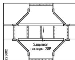
Для создания Т- и Х-образных отводов кабельной трассы. Используется с кабельными лестницами КHZ, КHZP, КHZSPZ, КHZSP и КHZPS любой ширины. Используйте Защитную накладку 28P нужной длины.
