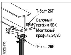
На потолочных балках, монтируйте Вертикальный подвес 2, как показано на верхнем рисунке. Когда толщина полки двутавровой балки не превышает 13 мм, используйте Балочный прижим 5BK-10 и Т-болт 26F М10x40. Для толщин полки двутавровой балки от 13 мм до 30 мм включительно, используйте Балочный прижим 5BK-30 и Т-болт 26F М10x50.
