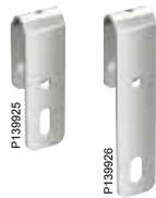
Крепится винтовой парой 2S M8x40 или W37 M8x35 (для скоб из нержавеющей стали) на боковом профиле кабельной лестницы для установки навесного оборудования под кабельной лестницей.
