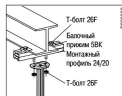
Монтируйте Вертикальный подвес 2F на потолочных балках, как показано на рисунке. Когда толщина фланца балки не превышает 13 мм, используйте Балочный прижим 5BK-10 и Т-болт 26F M10x40. Для толщин фланца балки от 13 мм до 30 мм включительно, используйте Балочный прижим 5BK-30 и Т-болт 26F M10x50.
