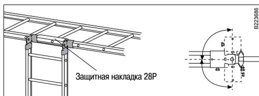
Гибкий соединитель 22 используется для создания вертикальных спусков. Используйте Защитную накладку 28P, которая может быть обрезана в нужный размер.
