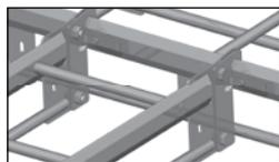
Накидной крюк 47 крепится к боковому профилю окрашенной кабельной лестницы шурупами-саморезами 4,8x13 через отжимные ушки крюка 47
