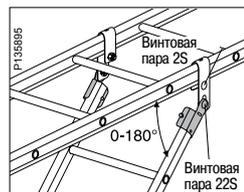
Скоба 12 и половина Гибкого соединителя 22 могут использоваться для отвода под кабельной лестницей с углом отклонения от 0° до 180°.
