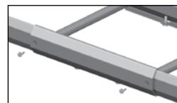
Соединитель 21 крепится шурупами-саморезами 4,8x13 через предусмотренные в соединителе отверстия. При соединении лестниц KNZ соединитель 21 следует сдвинуть в сторону от центра примерно на 20 мм чтобы саморез не попал в отверстие перемычки кабельной лестницы.
