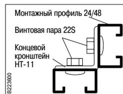
Концевой кронштейн NT-11 может использоваться для соединения под прямым углом двух Монтажных профилей 24/48 с задними сторонами, направленными к присоединяемым элементам.
