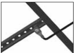
Кабельная лестница имеет соответствующий переходник для уравнивания потенциалов, с резьбой под винт M8 с обоих концов переходника.
