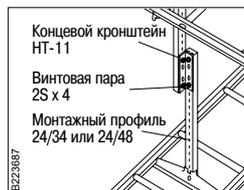
Концевой кронштейн NT-11 делает возможным монтаж пересекающихся кабельных лестниц на одном Вертикальном подвесе.
