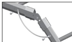
При установке гибкого соединителя 22 должны использоваться шурупы-саморезы 4,8x13 и многожильные медные перемычки сечением не менее 10 мм<sup>2</sup>
