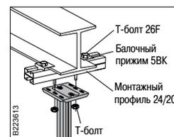
Монтируйте Вертикальный подвес 20 на потолочной балке как показано на рисунке. Когда толщина полки двутавровой балки не превышает 13 мм, используйте Балочный прижим 5BK-10 и Т-болт 26F M10x40. Для толщин полки двутавровой балки от 13 мм до 30 мм включительно, используйте Балочный прижим 5BK-30 и Т-болт 26F M10x50.
