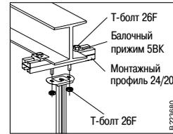
Монтажный профиль 24/20 также может быть использован для крепления вертикальных подвесов к двутавровым балкам. Это потребует использования четырех Т-болтов 26F.
