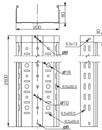
**Материал** Рулонная сталь. Исполнения: сталь, оцинкованная по методу Сендзимира; окрашенные лотки
