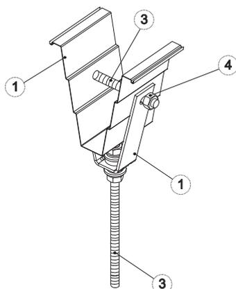
Для установки Крепления (1) на Профилированный лист (2) требуется предварительное сверление или перфорация гребня листа. В гребень помещается верхняя часть Крепления (1), в отверстия которой продевается предварительно нарезанная по ширине гребня Шпилька (3), которая фиксируется на гребне двумя Гайками (4). Шпилька (3) для подвеса лотка ввинчивается в отверстие струбцины, снабженное гайкой и фиксируется Гайкой на определенной высоте с нижней стороны Крепления.
