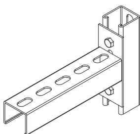
1. Предварительный монтаж гайки на резьбовой части болта.
