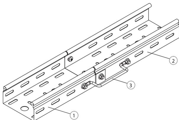
Соединение заземляющего проводника производится на стыке соединенных между собой Лотков. Один конец заземляющего Проводника (3) крепится снаружи к Лотку (1) одним винтовым комплектом через отверстие в боковой стенке Лотка (1). Второй конец заземляющего Проводника (3) крепится снаружи по боковой стенке Лотка (2) одним винтовым комплектом. Крепление производится в следующем порядке: Винт крепится изнутри со стороны Лотка, Гайка – снаружи.
