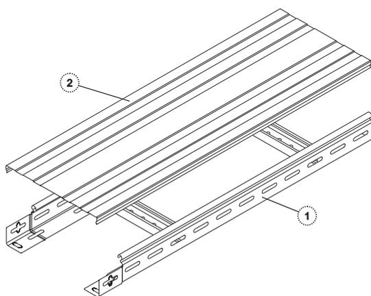
Крышка (1) совмещается с замком Лотка (2) и с небольшим усилием защелкивается.
