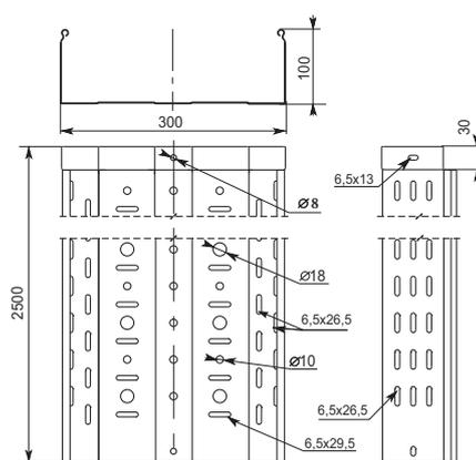
**Материал** Рулочная сталь. Исполнения: сталь, оцинкованная по методу Сендзимира; окрашенные лотки
