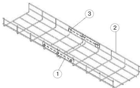
Соединяемые Лотки (2) стыкуются вплотную. СПЛП (1) прикладывается к боковой стенке соединяемых Лотков (2). Пластина СПЛО20 (3) прикладывается изнутри Лотка (2) к СПЛП, охватывая своим углублением проволоку лотка, после чего притягивается винтом и гайкой из комплекта СПЛО20.
