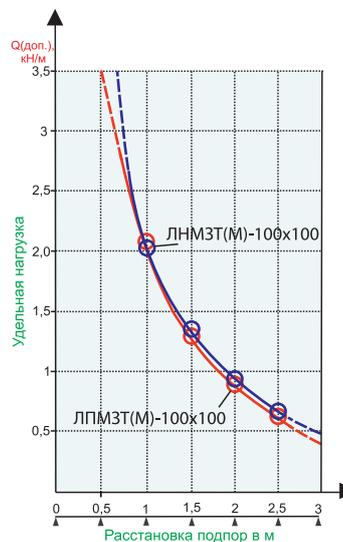
График отражает безопасную рабочую нагрузку (БРН - максимальная нагрузка, которая может быть безопасно приложена к системе в нормальных условиях), рекомендуемую к применению при проектировании кабельных трасс. БРН составляет 80% от данных, полученных при испытаниях на нагрузку по ГОСТ Р 52868-2007 с соблюдением следующих условий:
