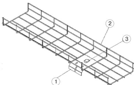
Пластина СК (1) крепится внутри Лотка (2) на один крепежный комплект СПЛО20 (3).
