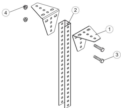
Закрепить Уголки монтажные (1) по бокам к Стойке потолочного подвеса (2), совместив верхнюю горизонталь и отверстия, с помощью двух Болтов (3) и двух Гаек (4).
