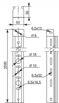
**Материал** Рулонная сталь. Исполнения: сталь, оцинкованная по методу Сендзимира; окрашенные лотки
