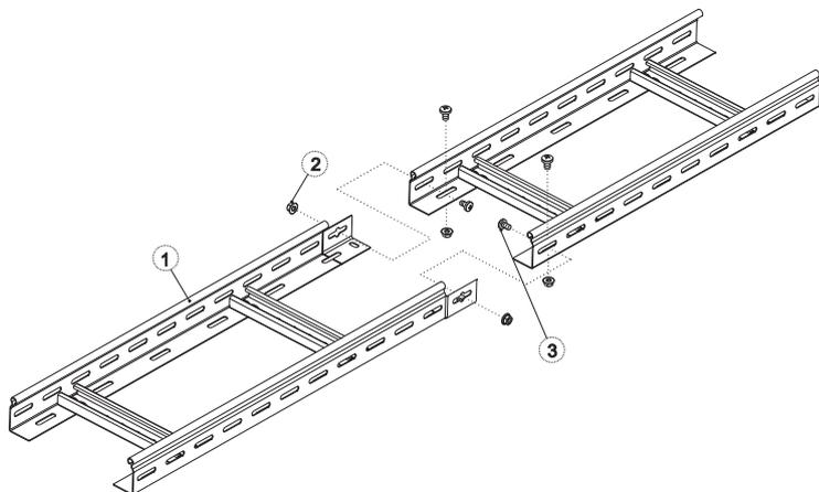
Соединяемые Лотки (1) стыкуются внахлест «папа-мама» и соединяются 4-мя винтовыми комплектами в следующей последовательности: Винт (3) – изнутри Лотка, Гайка (2) – снаружи Лотка.
