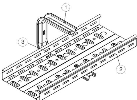
Способ крепления Подвеса (1) к потолку выбирается в зависимости от материала потолка и расчетной нагрузки. Лоток (2) укладывается на полку закрепленного Подвеса (1) и фиксируется двумя Винтами (3) и двумя Гайками.
