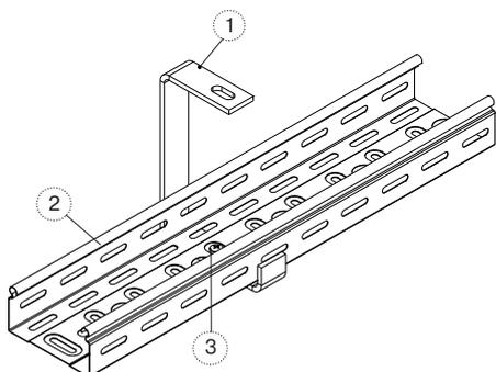
Способ крепления Подвеса (1) к потолку выбирается в зависимости от материала потолка и расчетной нагрузки.
