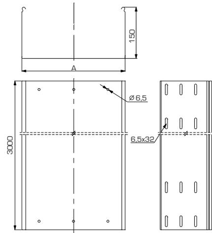
**Материал** Рулонная сталь. Исполнения: сталь, оцинкованная по методу Сендзимира; горячеоцинкованная сталь; нержавеющая сталь; окрашенные лотки
