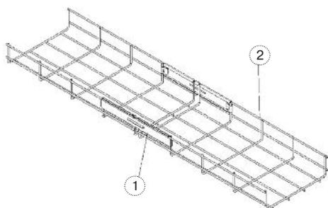
Соединяемые Лотки (2) стыкуются вплотную. СПЛБ (1) прикладывается к боковой стенке соединяемых Лотков (2) таким образом, чтобы проволока Лотка (2) попала в соответствующие углубления СПЛБ. В отверстие бокового загиба вставляется отвертка или иной инструмент, боковой загиб с усилием загибается, охватывая проволоку лотка.
