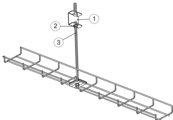
Способ крепления Кронштейна (1) к потолку выбирается в зависимости от материала потолка и расчетной нагрузки. Шпилька (3) фиксируется на Кронштейне (1) двумя Гайками (2).
