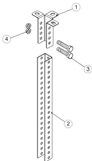
Закрепить Унитарный кронштейн потолочный (1) по бокам к Стойке потолочного подвеса (2) с помощью двух Болтов и двух Гаек со стопорным буртиком (4).
