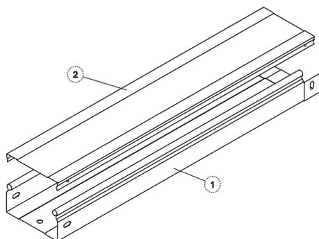
Крышка (2) совмещается с замком Лотка (1) и с небольшим усилием защелкивается.
