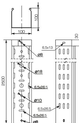
**Материал** Рулонная сталь. Исполнения: сталь, оцинкованная по методу Сендзимира; окрашенные лотки
