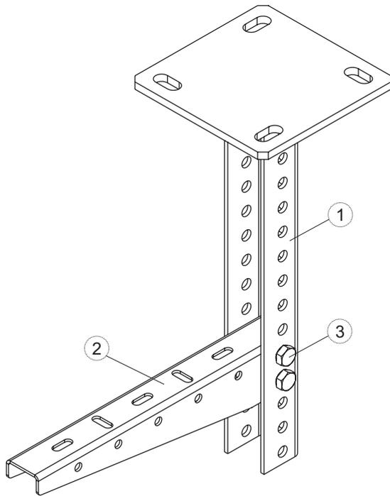
В Стойку потолочную сварную (1) на нужном уровне вставляется Консоль подвеса (2). Снизу, внутрь профиля Консоль подвеса (2) и Стойки потолочной сварной (1) вставляется Распорка для потолочного крепления и фиксируется Болтами (3) и Гайками.
