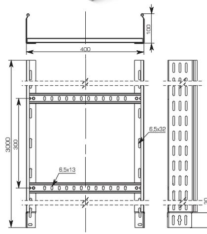
**Материал** Рулонная сталь, оцинкованная методом Сендзимира в агрегатах непрерывного цинкования
