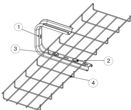
Соединитель СПЛО20 используется для крепления проволочного лотка к несущим конструкциям СППУ (1) (КПН, ПНУ, СПП и т.д.). Пластина СПЛО20 (2) прикладывается изнутри Лотка (4), охватывая своим углублением проволоку лотка, после чего притягивается Винтом (3) и Гайкой.
