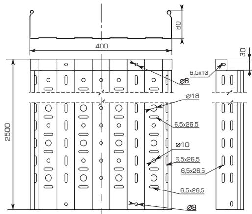
**Материал** Рулонная сталь. Исполнения: сталь, оцинкованная по методу Сендимира; окрашенные лотки
