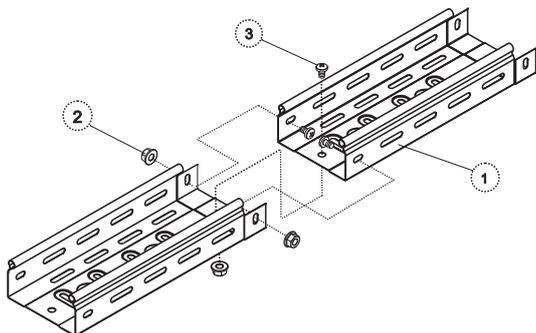
Соединяемые Лотки (1) стыкуются внахлест («папа-мама») и соединяются 3-мя винтовыми комплектами в следующей последовательности: Винт(3) – изнутри Лотка. Гайка (2) устанавливается снаружи, со стороны борта лотка.
