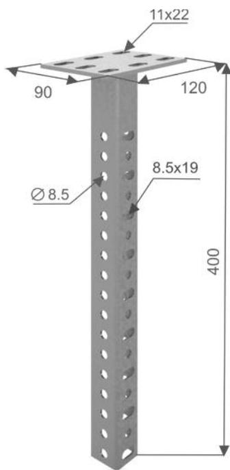
Подвес СПСу состоит из стойки с приваренной к торцу пластиной. К подвесу крепится консоль КПН размером от 100 до 600 мм или кронштейн КОД размером от 100 до 600 мм. СПСу крепится к потолку четырьмя анкерами или дюбелями.
