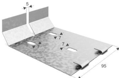
Спуск кабельный СК позволяет осуществлять вывод кабеля параллельно, либо перпендикулярно оси трассы, через дно лотка, при этом сохраняя плавный радиус изгиба кабеля или пучка кабелей.
