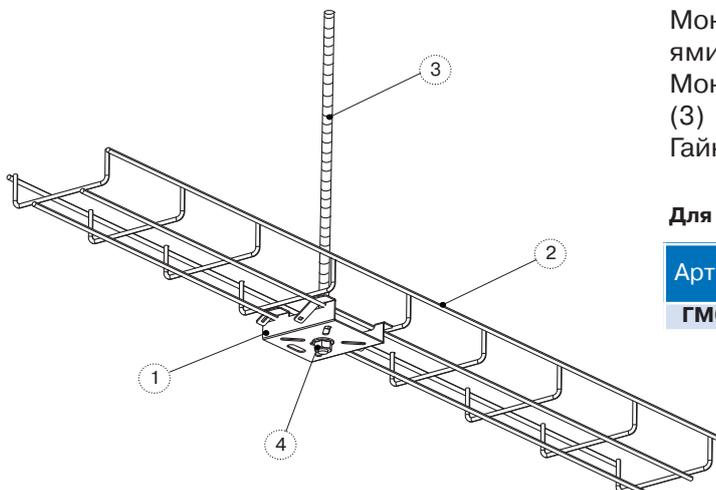
Монтажная плата (1) фиксируется между прутьями проволоки Лотка (2), затем «усики» Монтажной платы отгибаются наружу. Шпилька (3) фиксируется к Монтажной плате (1) двумя Гайками (4).
