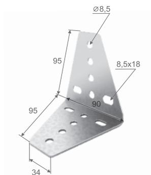
Пара уголков монтажных УМ используется для крепления стоек СПТ (400) и СПТЗ (2900) к потолку или к полу.
