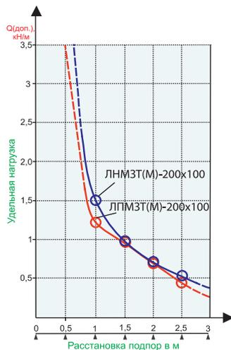
График отражает безопасную рабочую нагрузку (БРН - максимальная нагрузка, которая может быть безопасно приложена к системе в нормальных условиях), рекомендуемую к применению при проектировании кабельных трасс. БРН составляет 80% от данных, полученных при испытаниях на нагрузку по ГОСТ Р 52868-2007 с соблюдением следующих условий:
