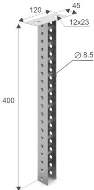
Подвес СПС состоит из потолочной стойки с приваренной к торцу пластиной. К подвесу крепится консоль КПН размером от 100 до 600 мм. СПС крепится к потолку двумя анкерами или дюбелями.
