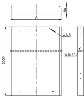
**Материал** Рулонная сталь. Исполнения: сталь, оцинкованная по методу Сендзимира; горячеоцинкованная сталь; нержавеющая сталь; окрашенные лотки
