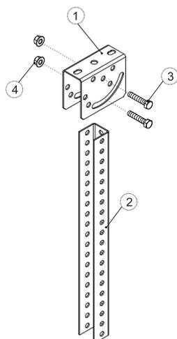
Способ крепления Держателя (1) к потолку выбирается в зависимости от материала потолка и расчетной нагрузки. Стойка подвеса (2) крепится к Держателю (1) через одно из отверстий Держателя с помощью одного Болта (3) и одной Гайки (4). С помощью одного Болта (3) и одной Гайки (4) Стойка подвеса (2) крепится к сектору прорези в Держателе (1). Дальнейшая затяжка Болта обеспечивает надежную фиксацию стойки в вертикальном положении.
