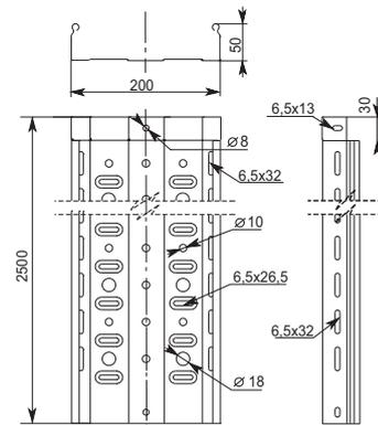
**Материал** Рулонная сталь. Исполнения: сталь, оцинкованная по методу Сендзимира; окрашенные лотки
