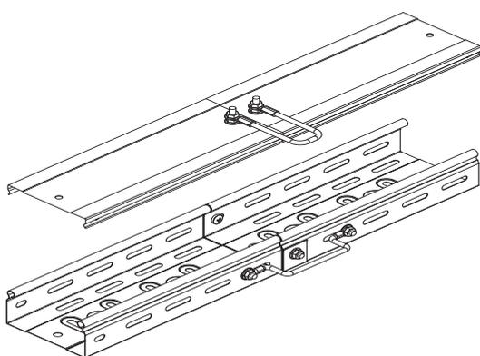
Два Винта М6х10 и две Гайки используются для соединения Лотков там, где нет Проводников заземления. Два Винта М6х20 и две Гайки используются для соединения Лотков между собой там, где есть Проводники заземления. Два оставшихся Винта М6х20 и две Гайки используются на крышках для соединения их друг с другом.
