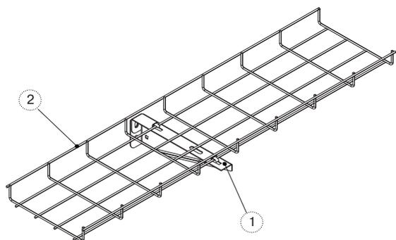
Способ крепления кронштейна к стене выбирается в зависимости от материала стены и расчетной нагрузки. Лоток (2) укладывается на Кронштейн (1) таким образом, чтобы проволока Лотка (2) попала в соответствующие выступы Кронштейна (1). В отверстия лепестка вставляется отвертка или иной инструмент, лепесток с усилием загибается, охватывая проволоку Лотка (2).
