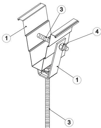
Для установки Крепления (1) на Профилированный лист (2) требуется предварительное сверление или перфорация гребня листа. В гребень помещается верхняя часть Крепления (1), в отверстия которой продевается предварительно нарезанная по ширине гребня Шпилька (3), которая фиксируется на гребне двумя Гайками (4). Шпилька (3) для подвеса лотка ввинчивается в отверстие струбцины, снабженное гайкой и фиксируется Гайкой на определенной высоте с нижней стороны Крепления.
