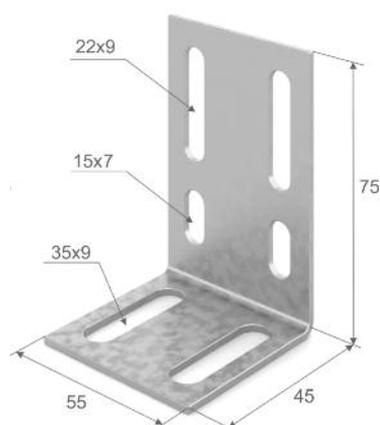
Используется для вертикального монтажа лотков-коробов и лестничных лотков НЛО. Скоба устанавливается с внешней стороны лотков. Для фиксации скобы к боковому профилю лотка используется винтовой комплект М6.
