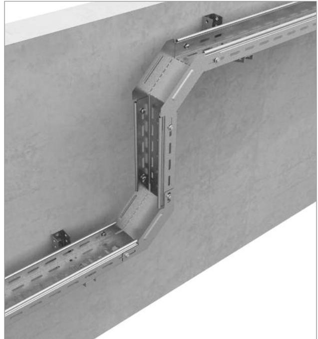
Лоток (2) вставляется внутрь Углового соединителя (1) до упора и соединяется 3-мя винтовыми комплектами в следующей последовательности: Винт (3) – изнутри, со стороны Лотка (2), Гайка (4) – снаружи, со стороны соединителя.
