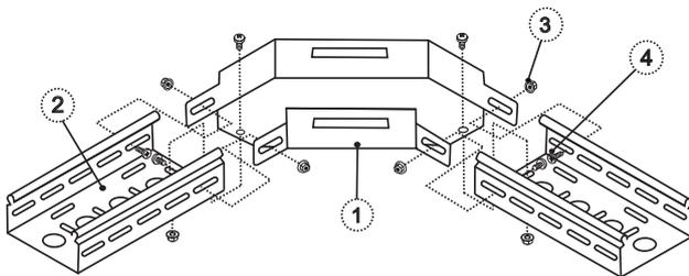
Лоток (2) вставляется внутрь Углового соединителя (1) до упора и соединяется 3-мя винтовыми комплектами в следующей последовательности: Винт (4) – изнутри, со стороны Лотка (2), Гайка (3) – снаружи, со стороны соединителя.
