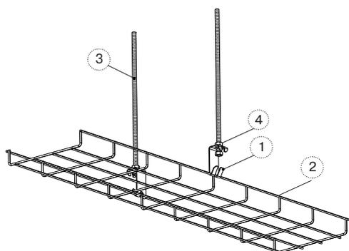
Крюк для подвеса проволочного лотка (1) фиксируется двумя Гайками (4) на Шпильке (3), закрепленной к потолку. Способ крепления шпильки к потолку выбирается в зависимости от материала потолка и расчетной нагрузки. Лоток (2) подвешивается на Крюк (1) за крайнюю продольную проволоку.
