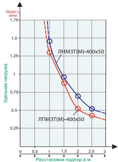
При заполнении лотка максимальным теоретически количеством кабеля (Шт.) указанного диаметра (D) и удельного веса (M) расчетная кабельная нагрузка (Q) позволяет установить опоры на расстояние Δ.
