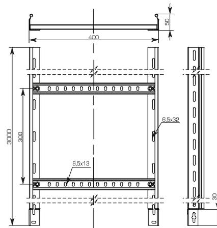
**Материал** Рулонная сталь, оцинкованная методом Сендимира в агрегатах непрерывного цинкования
