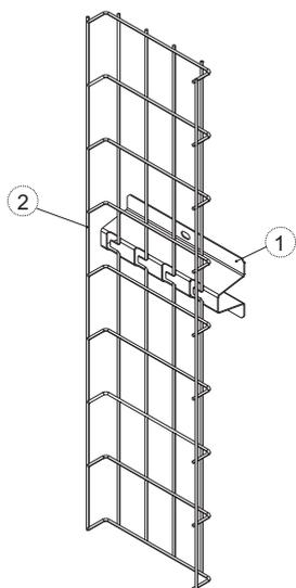
Лоток (2) укладывается на Держатель (1) таким образом, чтобы проволока Лотка (2) попала в соответствующие отверстия держателя. В отверстия лепестка вставляется отвертка или иной инструмент, лепесток с усилием загибается, охватывая проволоку Лотка (2).
