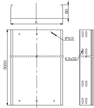
**Материал** Рулонная сталь. Исполнения: сталь, оцинкованная по методу Сендимира; горячеоцинкованная сталь; нержавеющая сталь; окрашенные лотки
