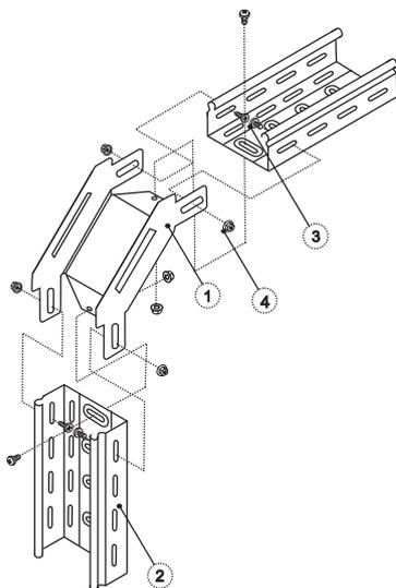
Лоток (2) вставляется внутрь Углового соединителя (1) до упора и соединяется 3-мя винтовыми комплектами в следующей последовательности: Винт (3) – изнутри, со стороны Лотка (2), Гайка (4) – снаружи, со стороны соединителя.
