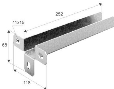
Суппорт СПН используется в сборе с планкой суппорта ПС для крепления лотков при напольном монтаже кабельной трассы. Это решение незаменимо при прокладке трасс под фальшполами и на кровле.
