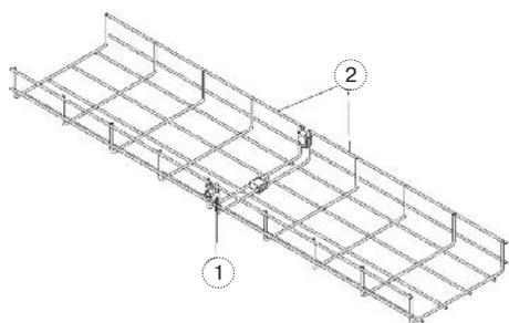
Соединяемые Лотки (2) стыкуются вплотную. Пластины соединителя (1) прикладываются с разных сторон Лотка (2), будучи ориентированными противоположным образом – в углубление для проволоки лотка одной пластины должен попасть один из соединяемых лотков, а в углубление второй пластины второй лоток. Пластины стягиваются при помощи винта и гайки из комплекта СПЛД20. Для соединения лотков используется крепление в трех точках, по каждому из бортов и по дну лотка.
