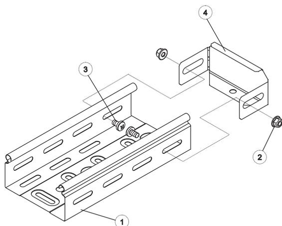
Торцевая Заглушка (4) крепится на торец Лотка (1) 2-мя винтовыми комплектами в следующей последовательности: Винт(3) – изнутри Лотка, Гайка (2) – снаружи, со стороны Лотка.
