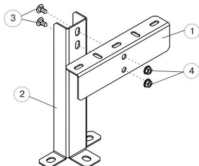
Суппорт СПН (2) своей основой вертикально устанавливается на пол. В верхней части Суппорта СПН (2) на перфорацию накладывается планка суппорта ПС (1), соответствующая ширине лотка. Закрепить Планку суппорта ПС (1) на Суппорте СПН (2) с помощью двух Винтов (3) и двух Гаек со стопорным буртиком (4).
