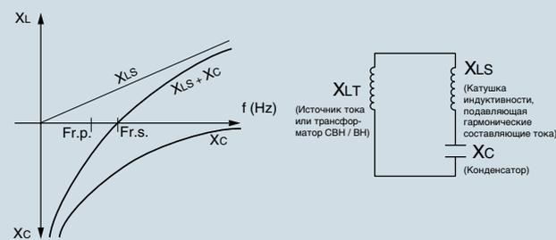
\*  $Fr.p.$ : частота параллельного резонанса для катушки индуктивности, подавляющей гармонические составляющие тока / конденсатора / трансформатора СН / ВН.
