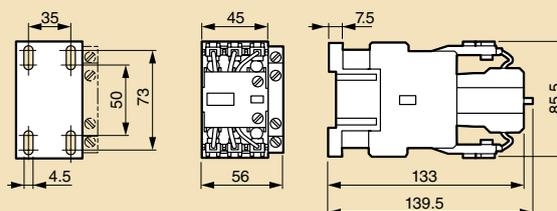
Контакторы типоразмера 3
