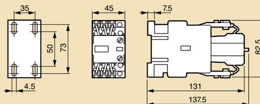
Контакторы типоразмера 2
