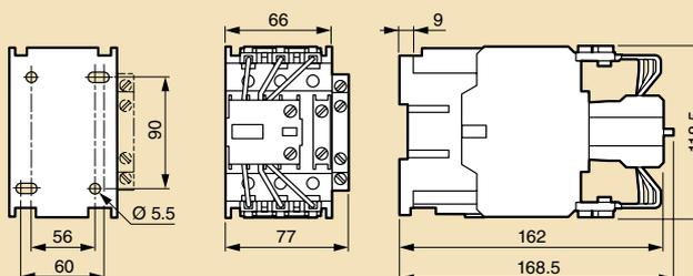
Контакторы типоразмера 5
