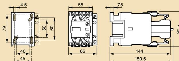
Контакторы типоразмера 4
